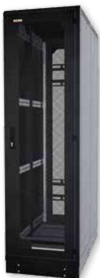
Konfigurace rozvaděče pro použití v horké / studené uličce vyžaduje dveře tahokov 83% pro snadné proudění vzduchu do/z rozvaděče
